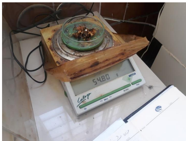
شکل ۵- اندازه گیری جرم نمونه آلی پسماند بعد از ۲۴ ساعت در آون برای محاسبه رطوبت
