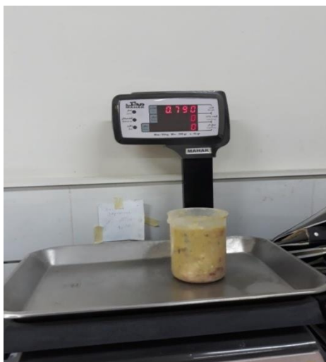
شکل ۶- توزین نمونه برای محاسبه چگالی
